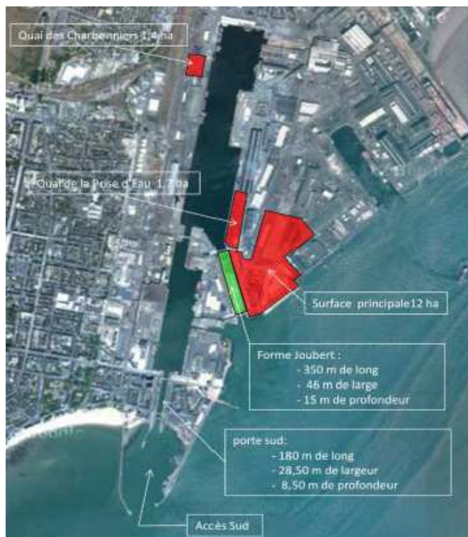
Figure 7 : Implantation de la base de pré-assemblage sur le port de Saint-Nazaire (source : dossier Natura 2000)
